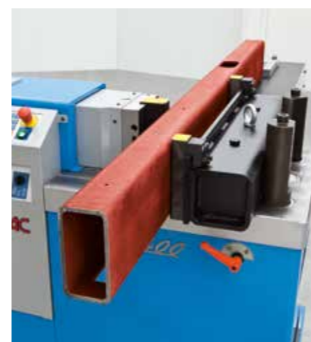
Narzędzie prostujące do rur, belek stalowych, płaskowników etc.
