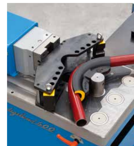
Narzędzie 2-wu szczękowe do gięcia rur o grubości ścianki 3/8" (17.2 mm) do 2" (60.3 mm) i prętów okrągłych, do 90°.
