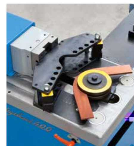
Narzędzie 2-wu szczękowe z systemem dwóch kotnierzy do gięcia płaskowników aż do 90°. Max 60 x 20 mm.
