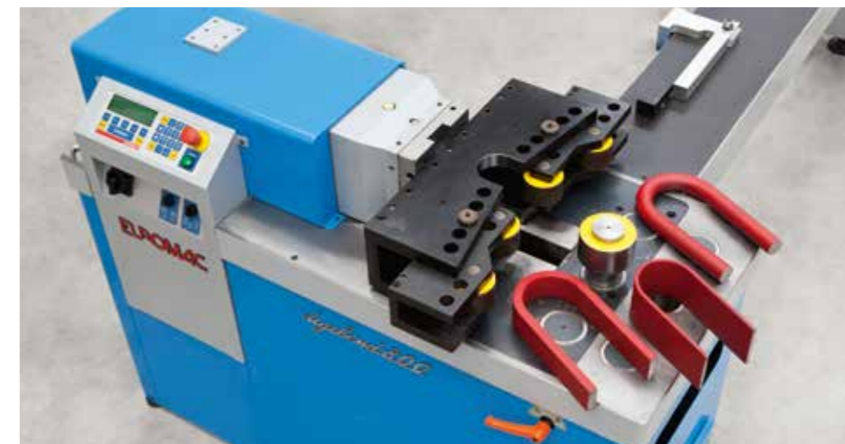
4-ro szczękowe narzędzie gnące dla kształtów okrągłych, kwadratowych, etc.. Pręty i rury aż do 180°. Max 100 x 20 mm lub \varnothing 50 mm.
