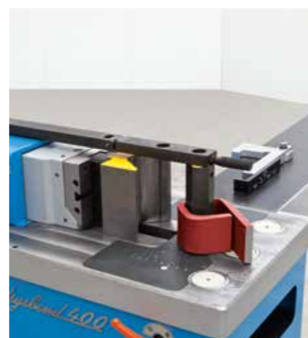
Pin gnący \varnothing 80 mm z blokadą górną dla gięcia profili zamkniętych z grubych płaskowników. Max 200 x 15 mm.
