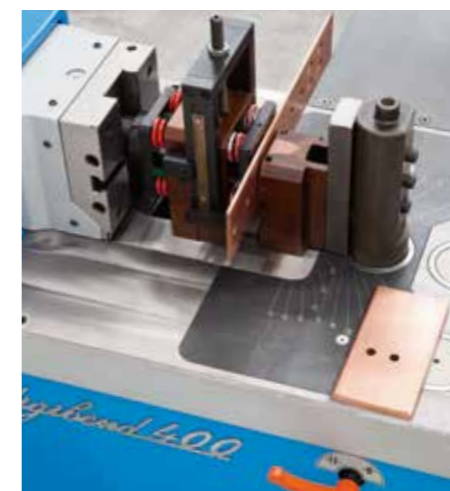
Jednostka wykrawająca dla otworów do \varnothing 30 mm. Max grubość 12 mm.
